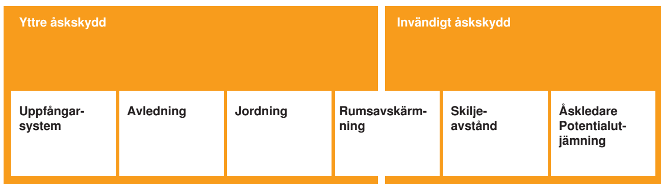
System för yttre och inre åskskydd
