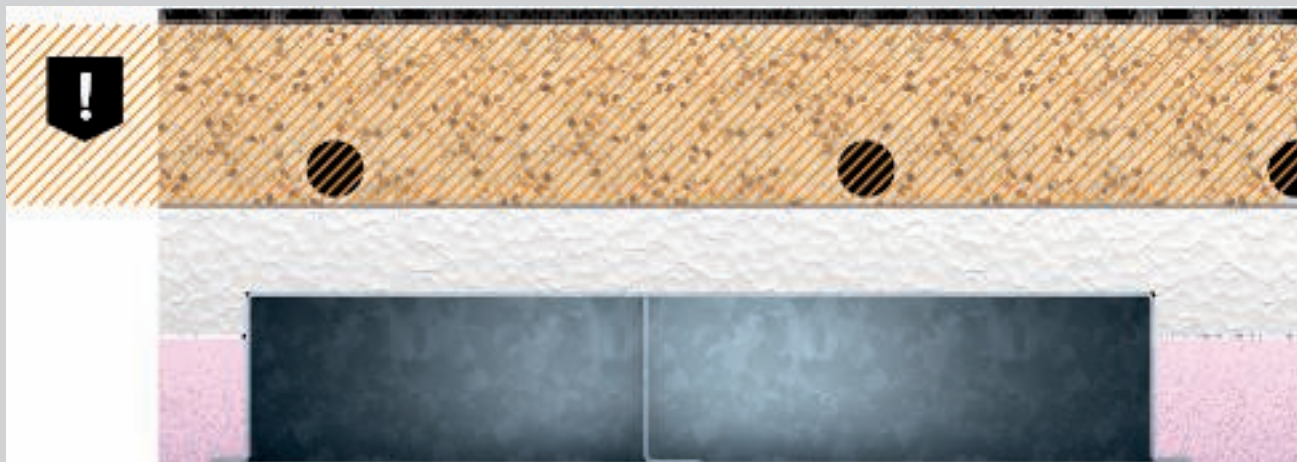
Nominell undergolvstjocklek för golvbelagt kanalsystem EÜK
